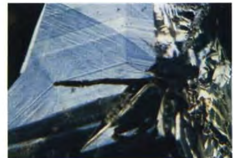
Fig. 8: Zaffiro sintetico ottenuto mediante fusione con fondente. Si notano bande di colore angolate a circa 60. o
