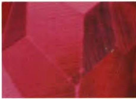
Fig. 1: Rubino sintetico, ottenuto per fusione alla fiamma, "Verneuil". Sono evidenti le caratteristiche strie curvilinee. X15.
