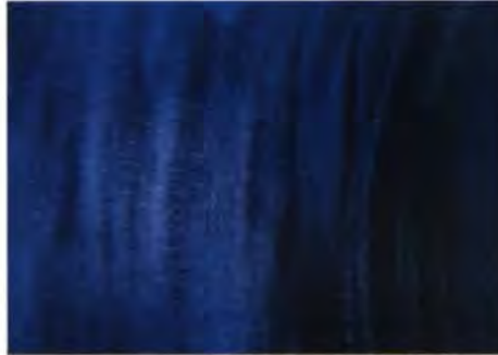
Fig. 2: Zaffiro sintetico ottenuto per fusione alla fiamma, "Verneuil". Bolle gassose allineate secondo strie curvilinee. X15.
