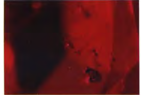
Fig. 6: Rubino sintetico ottenuto mediante fusione con fondente. Sono presenti residui di fondente con abito lamellare od, a volte prismatico tozzo, tipici delle sintesi "Chatham". X25.
