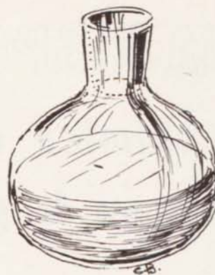
FIG. 4 - Nella stessa emulsione, trattata preventivamente con una sostanza tensioattiva, le due fasi non si separano più anche col trascorrere del tempo. Siamo in presenza di una « emulsione stabile ».
